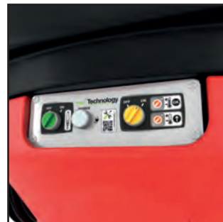
Elektromechanische Steuerbox ohne Werkzeug demontierbar
